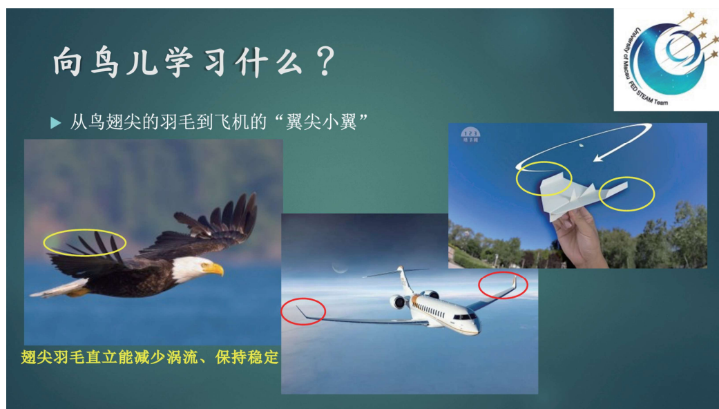
圖 4 從鳥兒飛行時翅尖的羽毛形態思考紙飛機機尖小翼的設計
