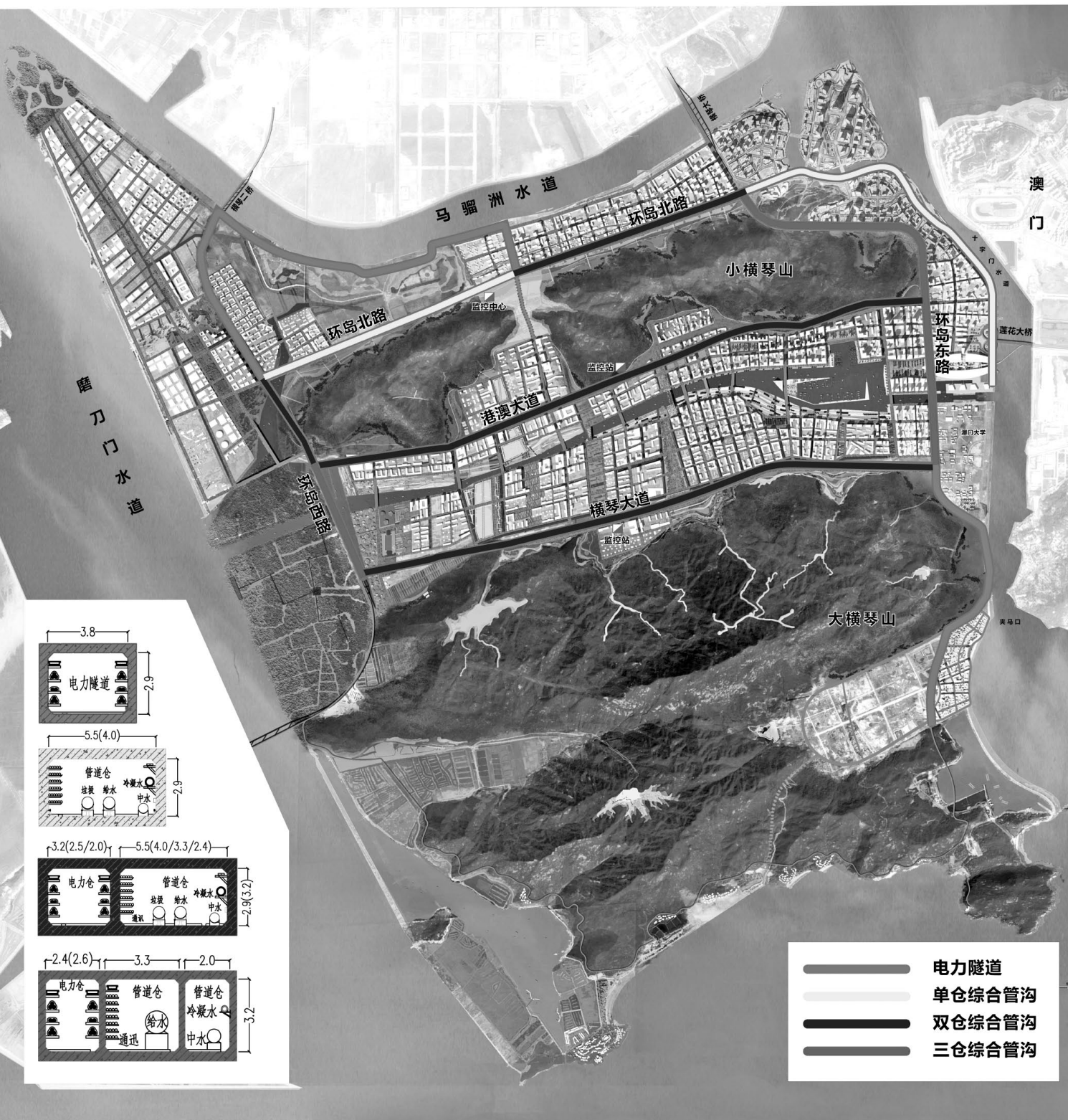
圖1 橫琴綜合管廊總平面佈置圖
